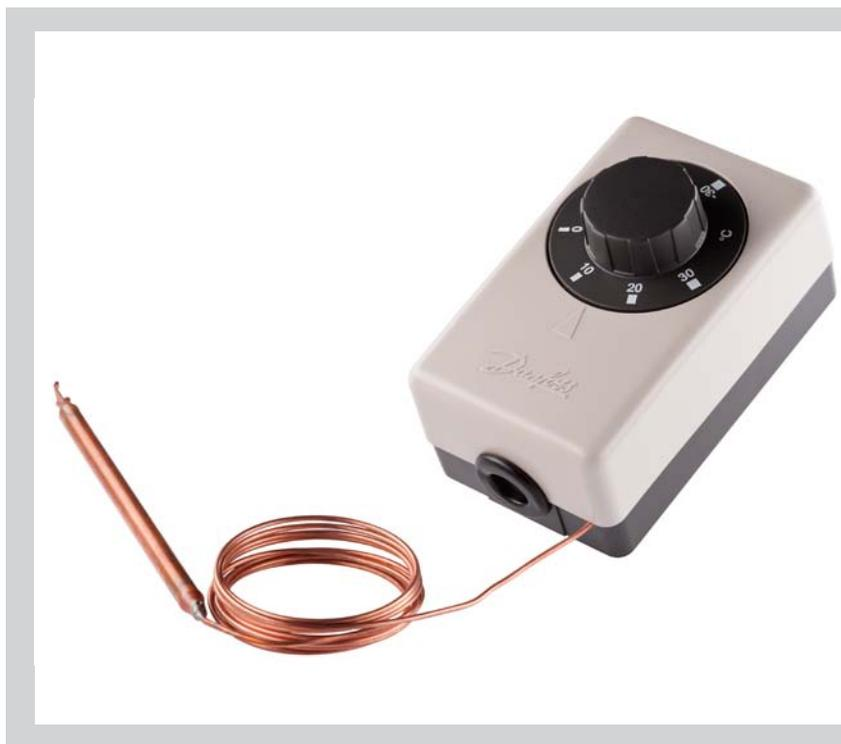
Реле температуры (термостат) типа UT представляет собой управляемый температурой электрический переключатель с капиллярной трубкой и термобаллоном из нержавеющей стали или меди.
