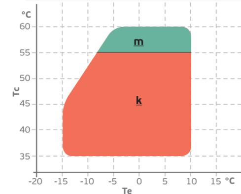
Tc - Температура конденсации | k - Окр. среды 32°C и газа на всасе 20°C
