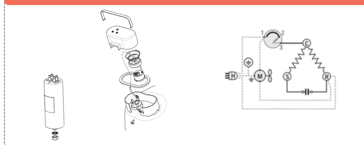
Габаритные размеры и схемы подключения
