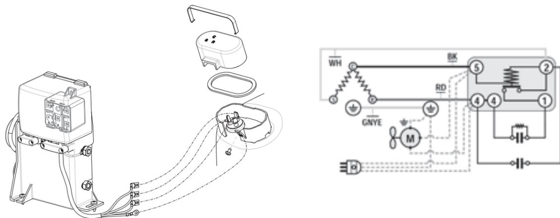
**SM017** - СЕРИЯ NJ Коробка CSR (Внешний предохранитель устройство от перегрузки)
