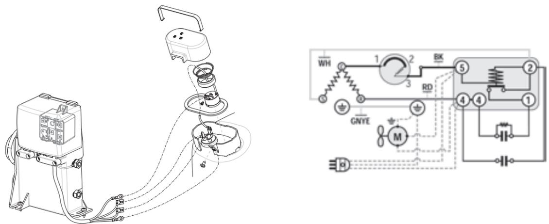
**SM18** - СЕРИЯ NJ 3-Phase (Встроенный предохранитель устройство от перегрузки)
